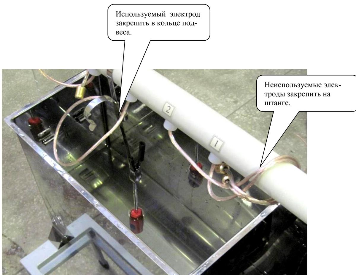
Рис.4.2 (а) Испытание электроинструмента
