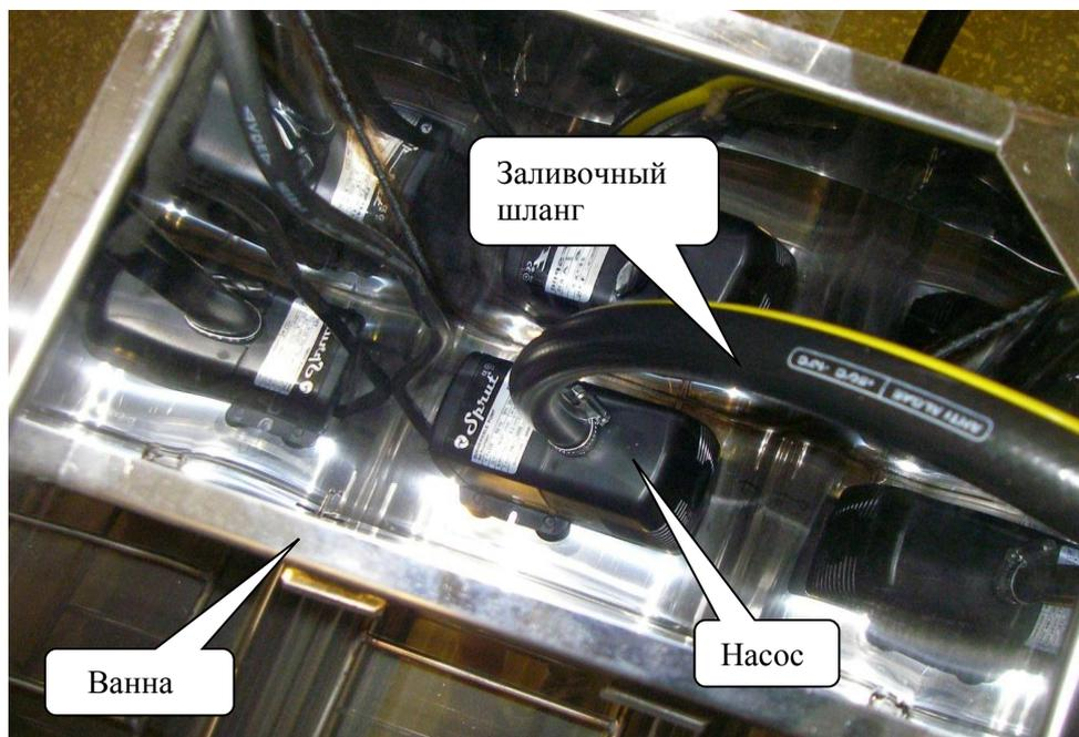
Рис. 7.2.Размещение насоса внутри ванны.
