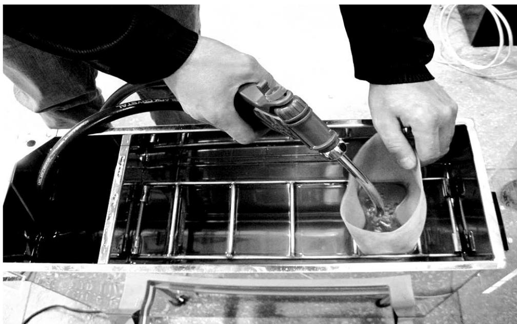
Рис. 8.12. Заполнение перчаток водой.
