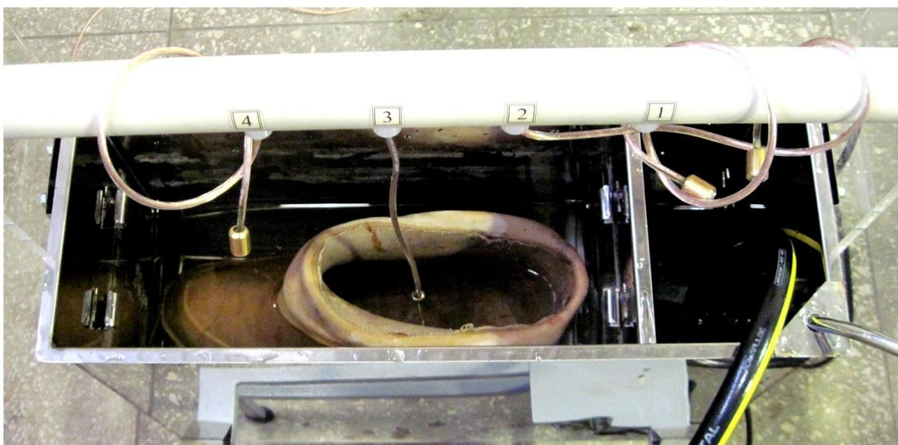
Рис. 8.16. Диэлектрический бот подготовленный к испытанию.
