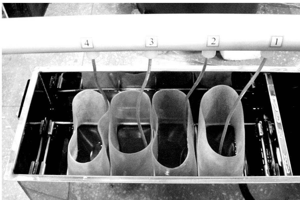
Рис. 8.14. Перчатки, подготовленные к испытанию.
